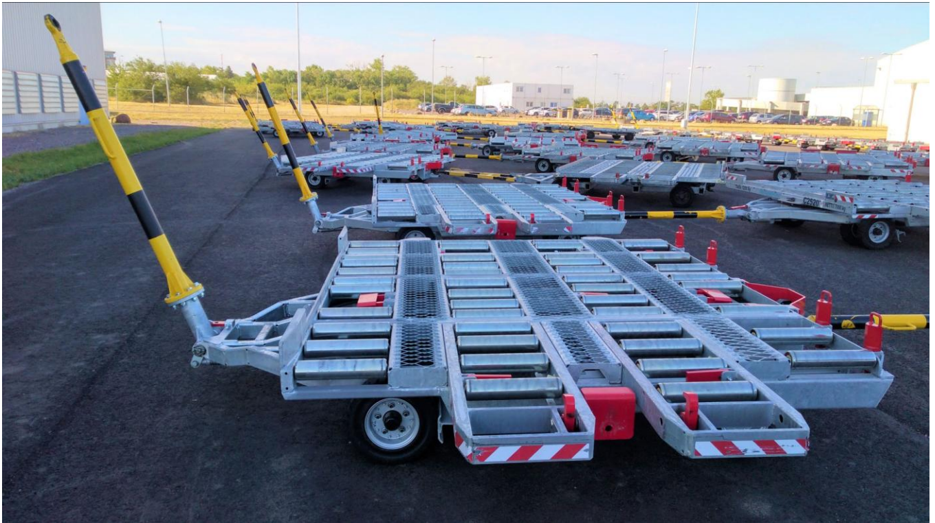
Abbildung: Container Dolly D 10-400-DQ-LS
